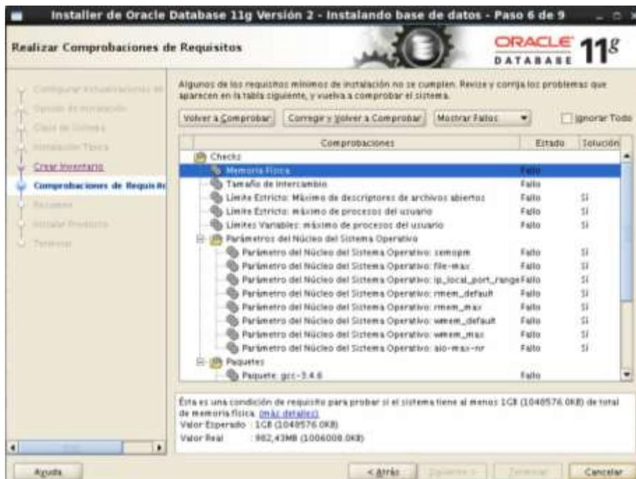
Fig28. Instalación de la BD Oracle - Comprobaciones de requisitos
